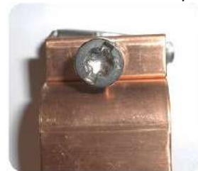
El tornillo es para destornillador TORX T25 o de cabeza plana
